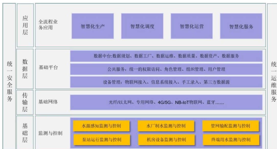
城镇智慧供水信息化工程总体框架
